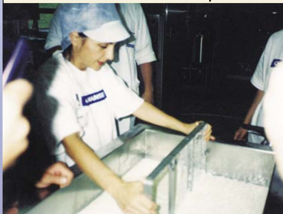
Обработка на сирната маса потсирена со CHY-MAX. Cutting and stirring the curd, clotted with CHY-MAX.
